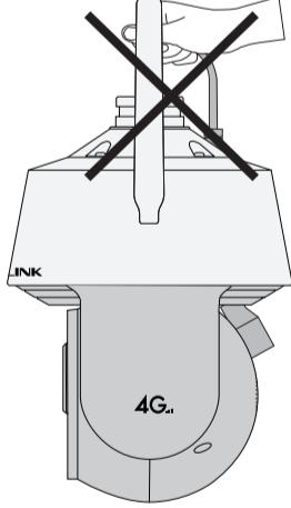
**注意：**安装过程中，请勿直接拉拽球机的尾线，否则会影响球机的性能。
